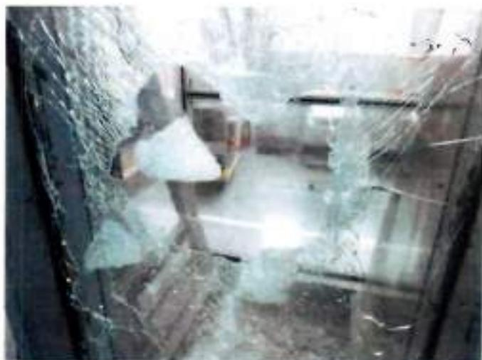
**Vitrage N°1, hauteur de chute 1200 mm**
