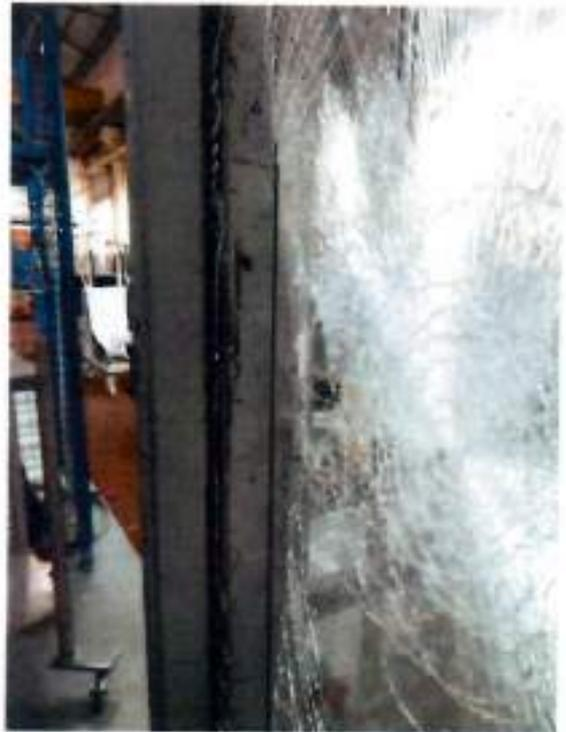
**Vitrage N°2, hauteur de chute 1200 mm**
