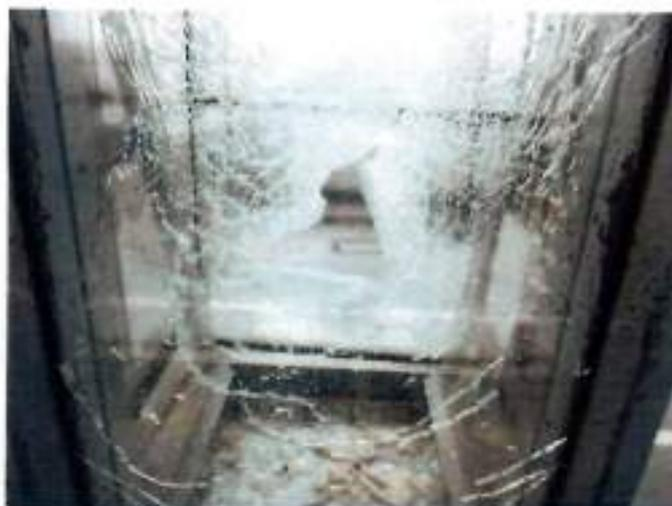
**Vitrage N°2, hauteur de chute 1200 mm**
