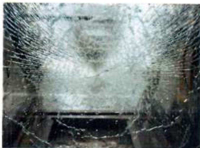
**Vitrage N°3, hauteur de chute 450 mm**
